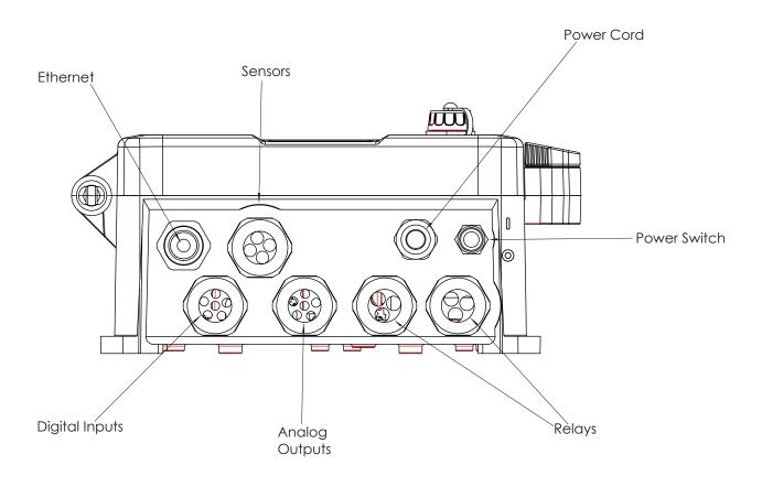
Figure 5 Conduit Wiring
