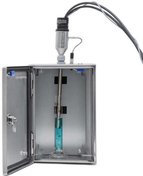
Sonda ramanowska w komorze pomiarowej
