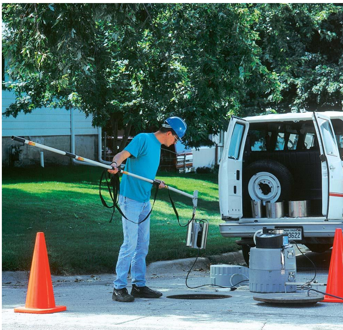
System montażowy sond pomiarowych. Na zdjęciu montaż sondy pomiaru przepływu AV zintegrowanej z przenośnym automatem do poboru prób 6712 (przepływomierz 750).
